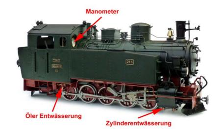
**Befüllen des Kessels**: öffnen Sie die Einfüllschraube und füllen Sie den Kessel komplett mit destilliertem Wasser oder gefiltertem Regenwasser. Saugen Sie mit den beiliegenden Einwegsritzen ca. 2 cm Wasser ab Oberkante Kessel wieder ab um den optimalen Wasserstand zu erreichen. Prüfen Sie nochmals den Ölstand im Öler. Schrauben Sie nun beide Füllschrauben vorsichtig zu, nicht zu fest da beide Schrauben mit O-Ringen abdichten.
